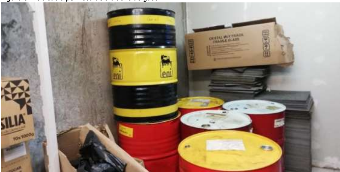
Figura 32. Ubicació perillosa dels bidons de gasoil
