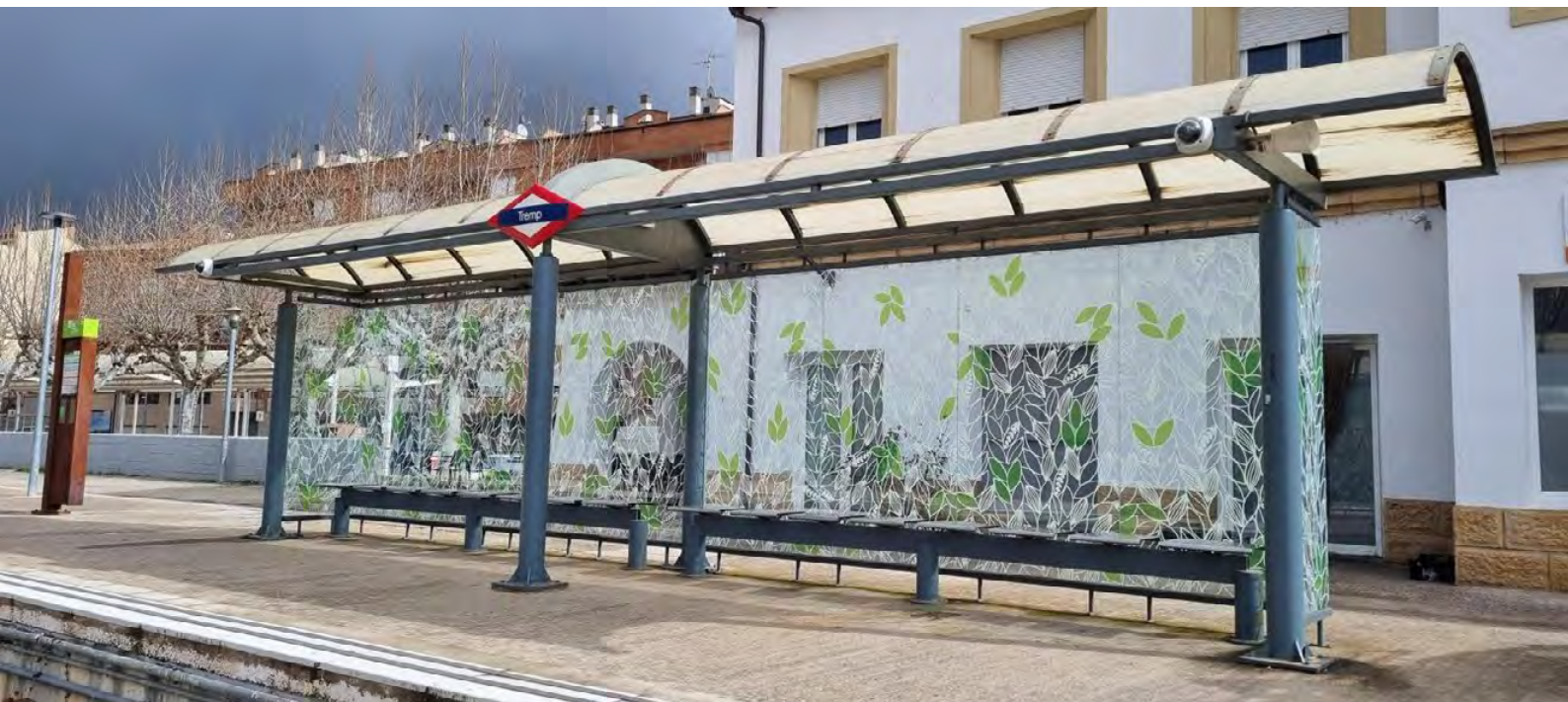
Imatge de la marquesina instal·lada a l'estació de Trem per evitar el xoc d'ocells arran d'una proposta sorgida dels Pressupostos Participatius d'FGC.
